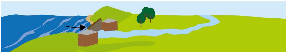
Bei Flut drückt das Wasser gegen die Sieltore. Sie schließen sich durch den Wasserdruck.
