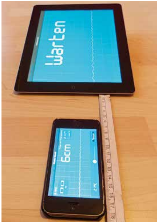
Abb. 1: Messung der Schallgeschwindigkeit mit mobilen Endgeräten
