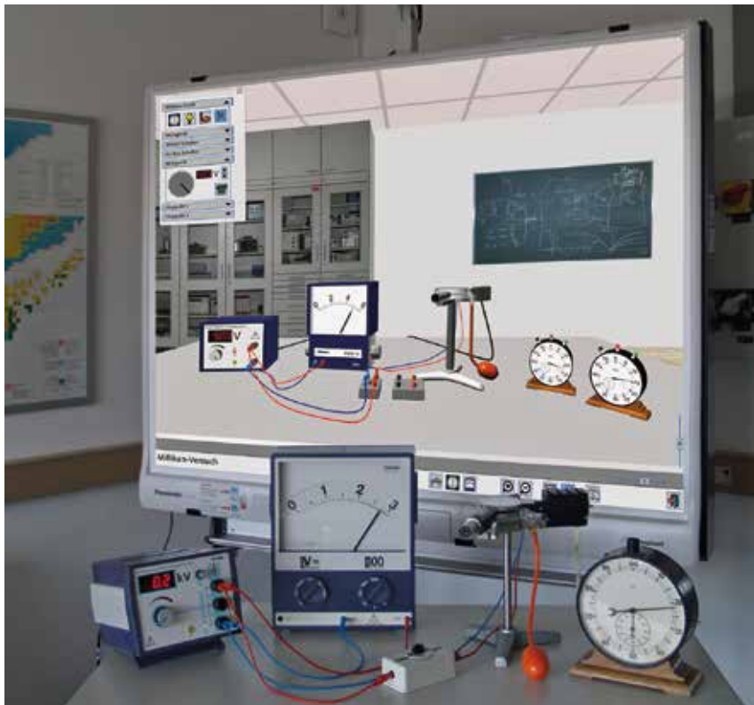
Abb. 1: Virtual-Reality-Experiment zum Millikan-Versuch auf einer interaktiven Tafel (Bildhintergrund) im Vergleich mit dem Realexperiment
