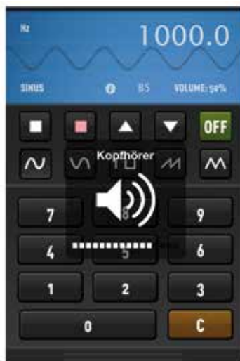
Abb. 2 b: Die gerätespezifische Lautstärke sollte auf ca. 12 (von 16) eingestellt sein, sodass bei einem Volume von 10 % ein Pegel von mehr als 60 dB gemessen wird.
