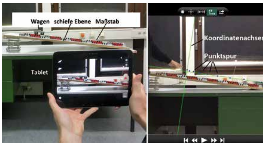
Abb. 4: (a) Versuchsaufbau und Aufnahme mit Tablet. (b) Bedienoberfläche von Video Physics (Vernier, 2014) mit gesetzten Messdaten (Punktspur). Das Koordinatensystem liegt entlang der Ebene (grün).
