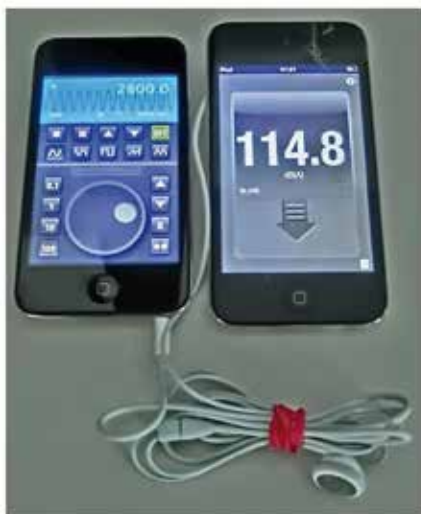
Abb. 2 a: Über Kopfhörer wird ein Sinuston variabler Amplitude auf das Mikrofon eines iPods gegeben und der Schalldruck gemessen.
