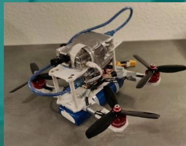
Das Auslesen von Daten des Controllers und das Versenden dieser mittels Python an den Raspberry Pi, welcher sich auf der Drohne befindet und die anschließende Erzeugung eines PPM-Signals (Pulse-Position Modulation, dt. Puls-Position Modulation) erlaubt uns die Steuerung mit einem Controller.
