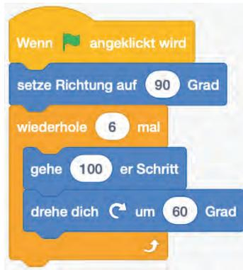
Dieses Beispiel würde dafür sorgen, dass die Figur zu Beginn nach rechts schaut und dann einmal ein Sechseck („6 mal“ „drehe dich um 60 Grad“) mit einer Schrittweite von 100 („6 mal“ „gehe 100er-Schritt“) abläuft.
