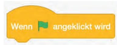
An das Ereignis können weitere Bausteine angeordnet werden. Dazu werden sie einfach an die gewünschte Position gezogen. Ein so geschaffenes Skript wird immer von oben nach unten Schritt für Schritt abgearbeitet. Ein Skript kann wie folgt aussehen:
