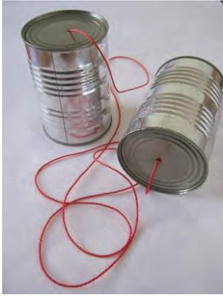
Nun befindet sich die Schnur als Verbindungskabel zwischen den beiden Dosen beziehungsweise Bechern. Jetzt nimmt sich jede und jeder eine Dose. Die beiden Telefonpartner entfernen sich so weit voneinander, dass die Schnur leicht gespannt ist. Sie darf nicht durchhängen. Sie darf auch nichts berühren oder berührt werden.
