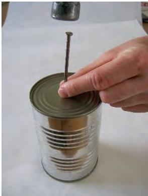
Danach schlägt man mit Hammer und Nagel je ein Loch in die Mitte der Unterseite beider Dosen. Wenn ihr Plastiktrinkbecher benutzt, solltet ihr einen Nagel über einer Flamme erhitzen und damit Löcher in die Becher brennen.
