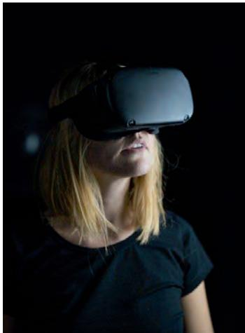
In einer virtuellen Realität (**Virtual Reality**, VR) wird hingegen gänzlich in eine computergenerierte Welt „eingetaucht“. Gängiges Mittel dazu sind sogenannte VR-Brillen (siehe linke Abb.).
