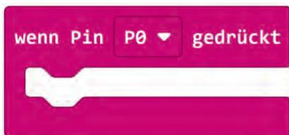
Für dieses Projekt kann der Pin P0 auf der linken Seite der Platine verwendet werden. P0 wird als gedrückt registriert, wenn der Pin mit Masse (-) verbunden ist. Nutze dies für deine Alarmanlage.
