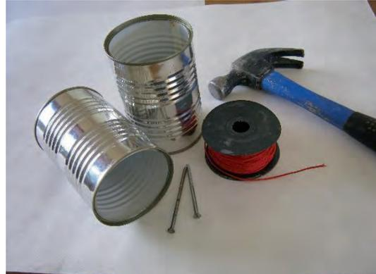
Die Konservendosen werden sauber gemacht und abgetrocknet. Nun muss man an der Stelle, an der früher der Deckel war, den inneren Rand mit dem Hammer plattklopfen. Sonst könnte man sich beim Hineinfassen in die offene Dose verletzen.
