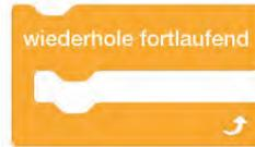
Alles was sich innerhalb dieses Bausteines befindet, wird immer wieder ohne ein definiertes Ende ausgeführt. Damit die Katze nun also mit einmal Drücken der grünen Flagge ganz nach rechts läuft, muss das Skript so aussehen:
