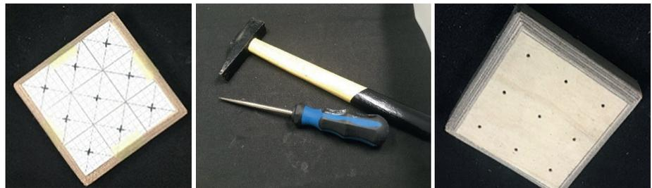
Abb. 3.1-5 bis 8: Anreißen der Bohrmittelpunkte
