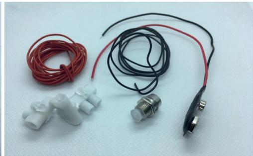
Abb. 3.5-5: Installationsmaterialien: Lüsterklemmen, LED-Fassung, Batterieclip, Schaltlitze
